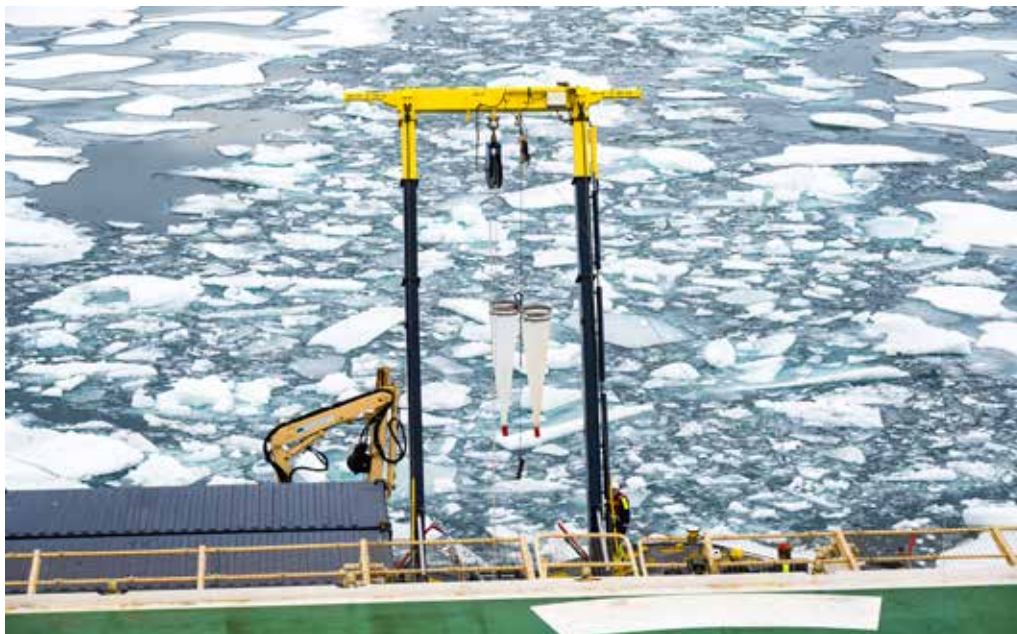
Een Bongo-net wordt te water gelaten tussen de ijsschotsen van Victoriafjord voor het verzamelen van plankton.
